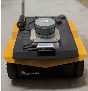
Robot: Clearpath Jackal (Velodyne Puck lidar)
